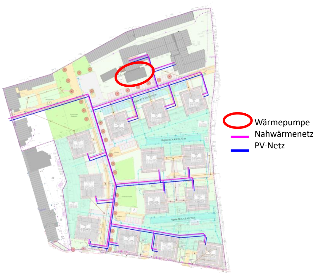
Abb. 8 Wärmeverteilung, Nahwärmenetz Quelle: aQua-thermic Ingenieurgesellschaft mbH
