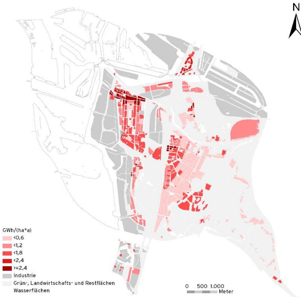
Abb. 3 Aktueller Wärme- und Warmwasserbedarf für die Energieparteien Haushalte und GHD im Jahr 2007 (inklusive Prozesswärme für GHD) im IBA-Modellraum [8]
