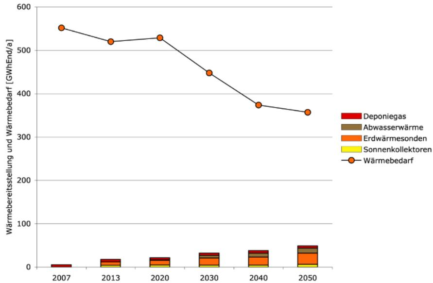
Abb. 7 Wärmebedarf und regenerative Wärmeerträge im Referenzszenario für die Energieparteien Wohnen und Arbeiten (GHD, ohne Industrie)
