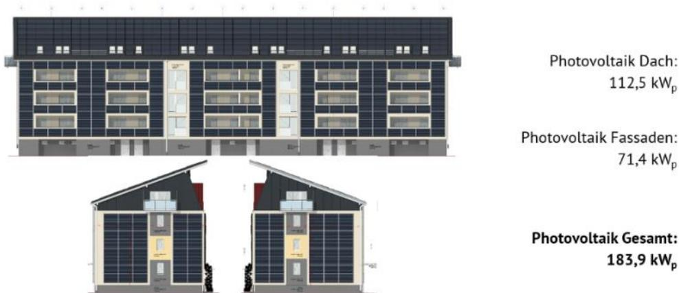
Die blauen Flächen auf dem Dach und an den Fassaden stellen die Photovoltaik-Module dar.
