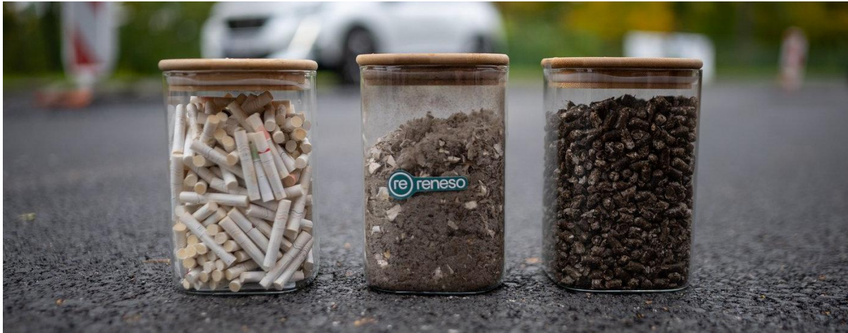
Abb. 1 Drei Phasen der Verarbeitung von Tabakabfällen: rohe Tabakschnitzel, Zwischenprodukt und Reneso-Fibers (Fasern) als Endprodukt. Bild: SCBSK
