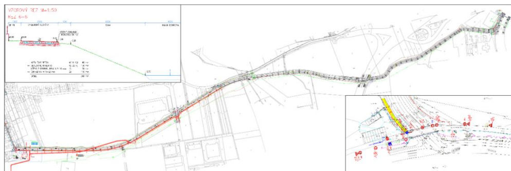
Obr. 1 Smerové a výškové usporiadanie cyklocestičky Nitra-Drážovce s napojením na JLR - PP Nitra-Sever (StavPros NR, 2020)
