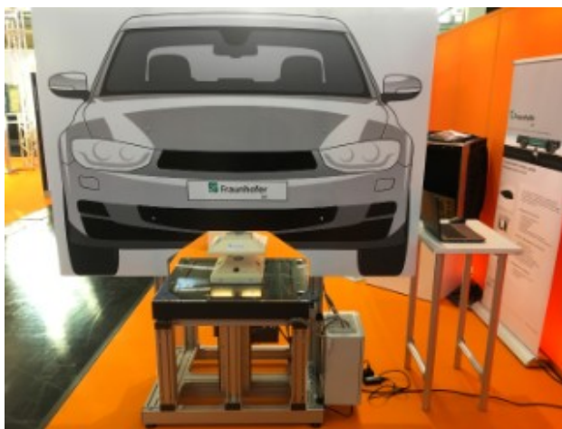
Obr. 5 Podpodlahový rychlonabíjecí systém
