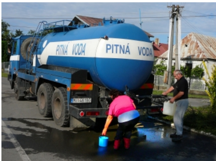
Obr. 3 Náhradne zásobovanie pitnou vodou pomocou automobilovej cisterny. [12]
