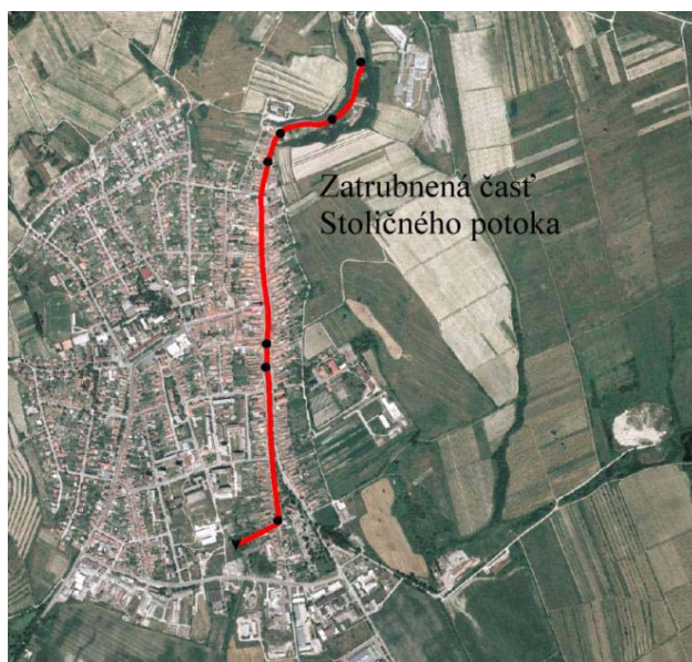
Obr. 4 Schéma zakrytých úseků korýt toků v Modře
