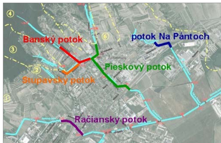
Obr. 3 Schéma zakrytých úsekov korýt tokov v Rači
