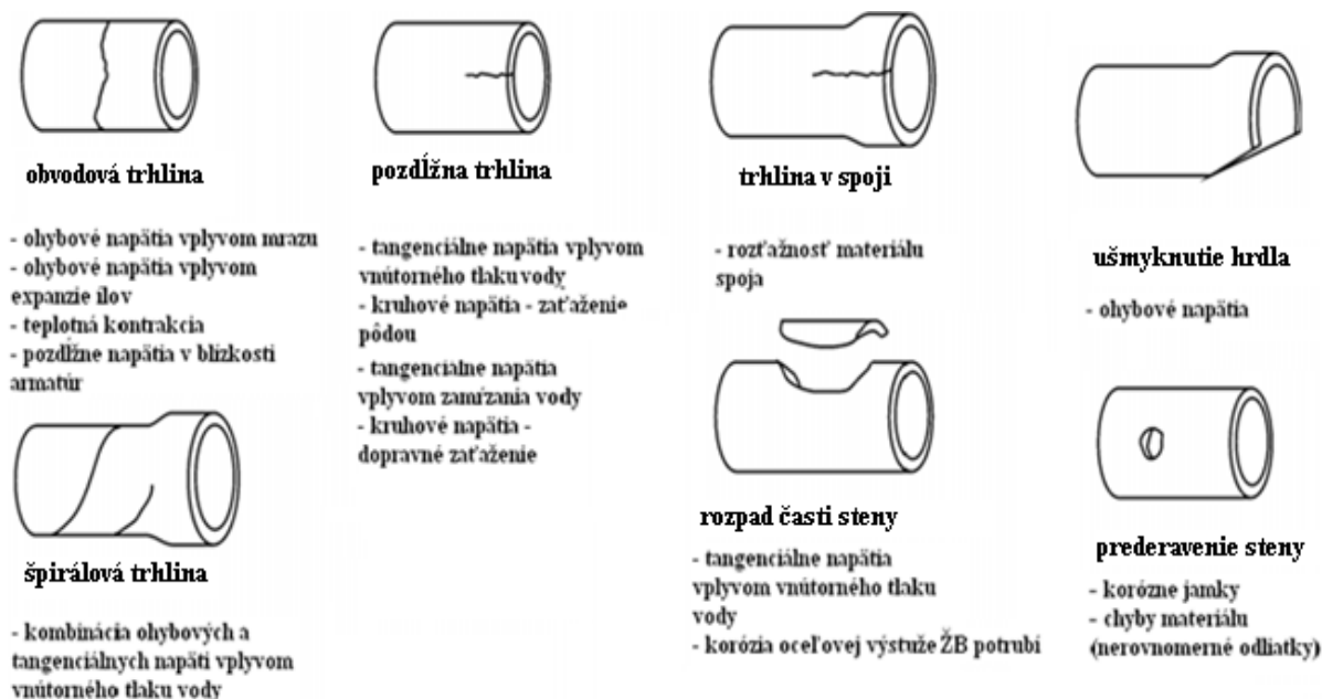
Obr. 3 Spôsoby a príčiny porušenia vodovodných potrubí [1]
