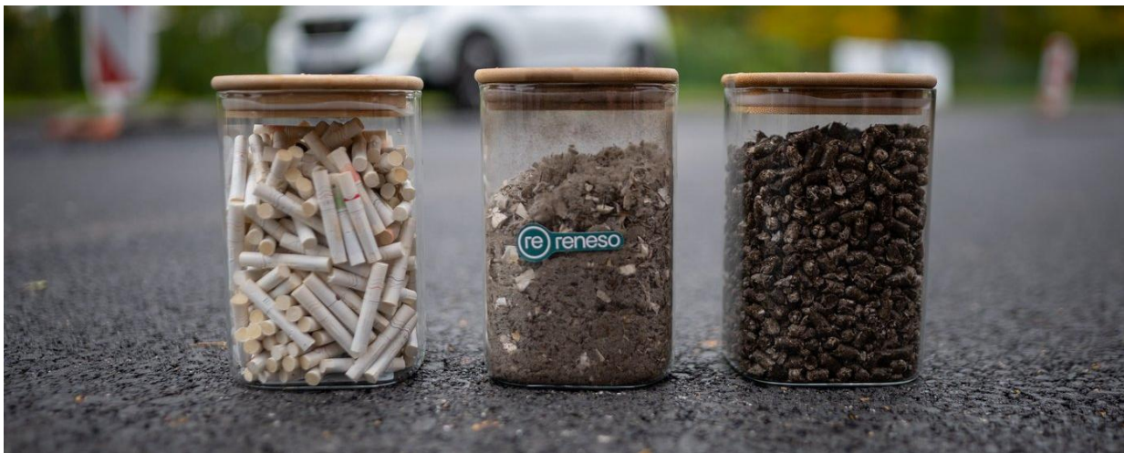
Obr. 1 Tri fázy spracovania tabakového odpadu: surové ohorky, medzistupeň spracovania a finálny produkt Reneso Fibers (vlákna). Fotografia: SCBSK
